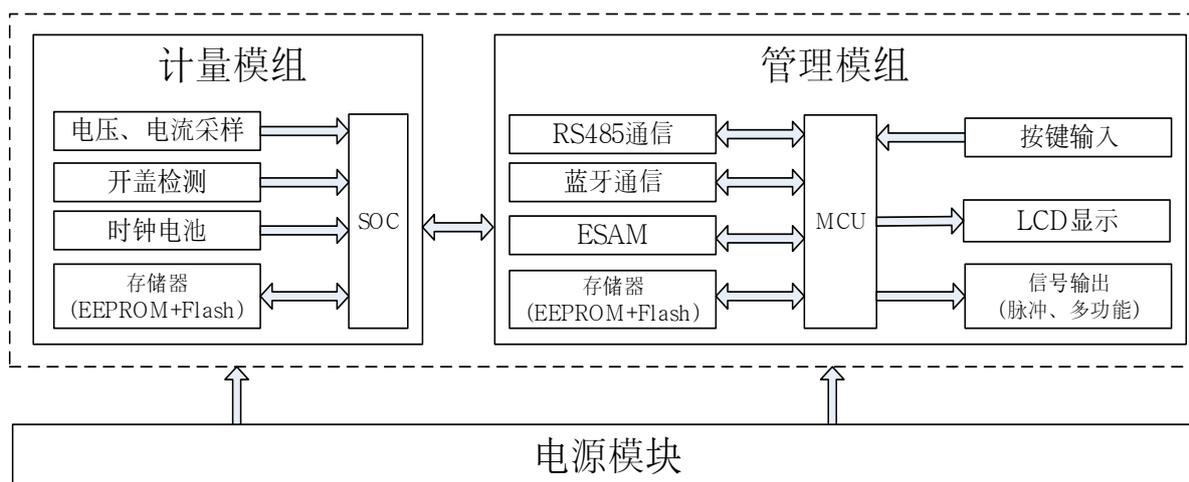
图 1 电能表工作原理
