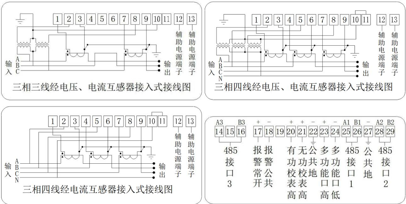
图 3 电能表接线端子功能示图
