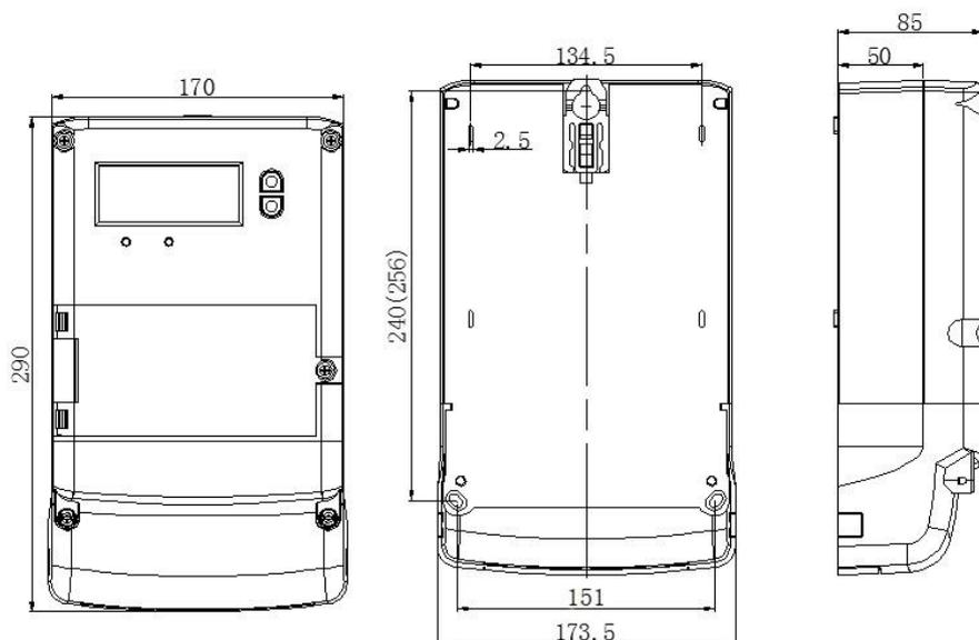
图 2 电能表外形示意图和安装尺寸简图
